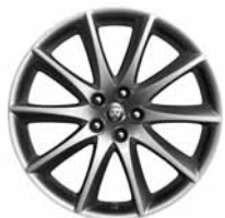
19" 10-SPOKE 'STYLE 1028' Sparkle Silver C45C Velgmaat voor/achter: 9,0J x 19"/10,0J x 19" Bandenmaat voor/achter: 245/45 ZR19/275/40 ZR19
